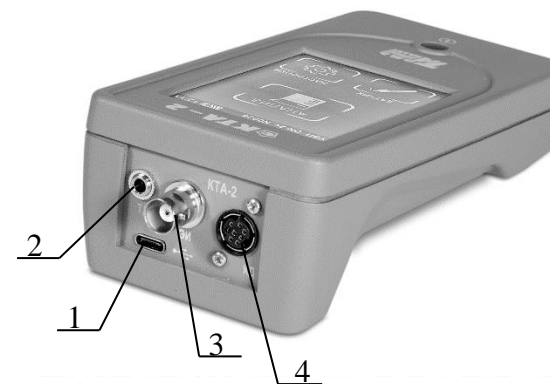
1 – разъём для подключения внешнего зарядного устройства; 2 – разъём внешнего термодатчика; 3 – разъём комбинированного электрода; 4 – разъём кондуктометрического датчика
